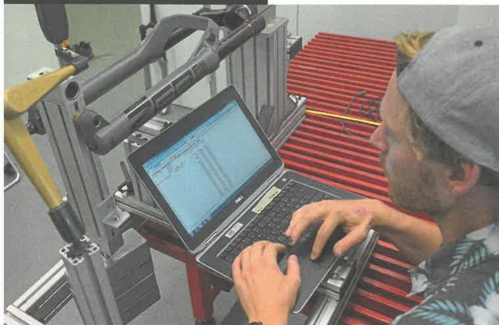
Steifigkeits-Check auf zusammen mit dem Prüfinstitut EFBE entwickelten Messständen.
