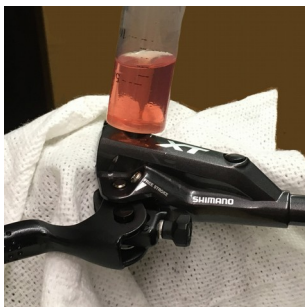
Abb. 23 Bei Shimano eine Spritze verwenden
