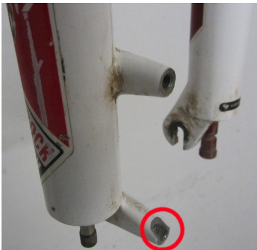
Abb. 40 Ausgerissene PM Aufnahme wegen einer zu kurzen Schraube, CanyonFreund@mtb-news.de -DANKE!
