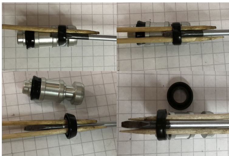
Abb. 33 Die Dichtungen vom Geberkolben abmachen
