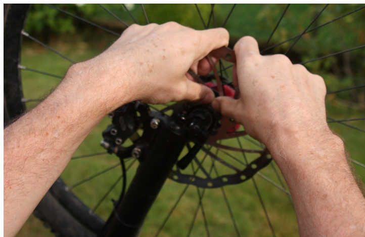
Abb. 17 Die Bremsscheibe nach außen ziehen.
