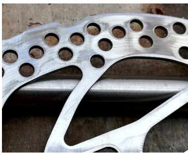
Abb. 3 Unebene Bremsscheibe, RudiRabe_MTB@mtb-news.de -DANKE!
