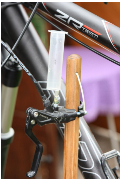
Abb. 22 Die Entlüftungsöffnung immer nach oben
