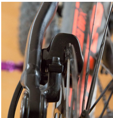
Abb. 39 Der Bremssattel stößt an den Rahmen, style-boarder@mtb-news.de -DANKE!
