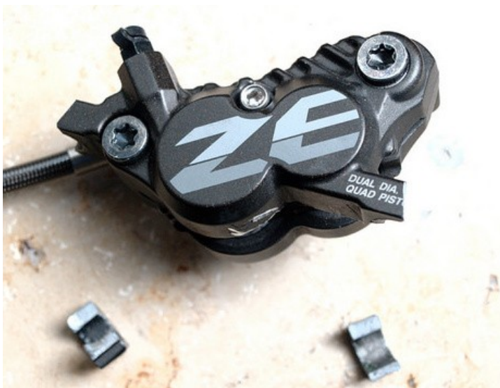
Abb. 37 Abgebrochener Bremssattel, niconj@mtb-news.de -DANKE!
