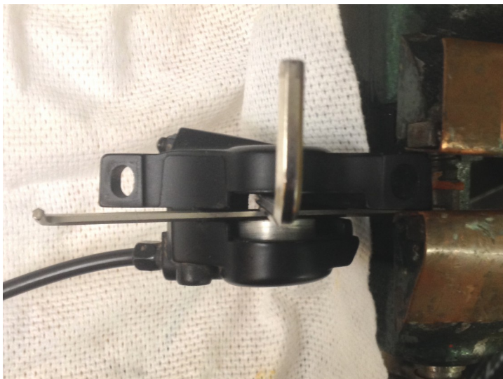
Abb. 27 Einen Bremskolben fixieren
