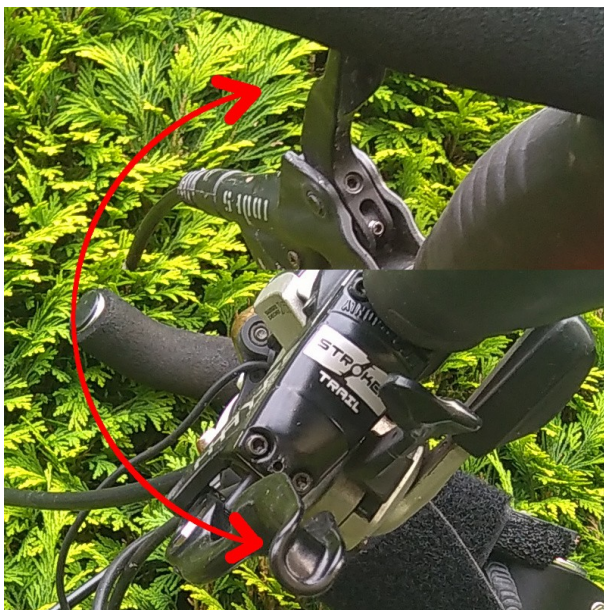
Abb. 52 Bremshebel drehbar montieren
