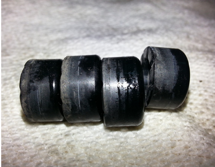
Abb. 29 Bremskolben einer AVID Code mit Ablagerungen, MeisterShredder@mtb-news.de -DANKE!
