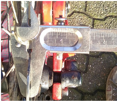
Abb. 65 Bremsscheibendicke messen, hier sind es 1,8mm
