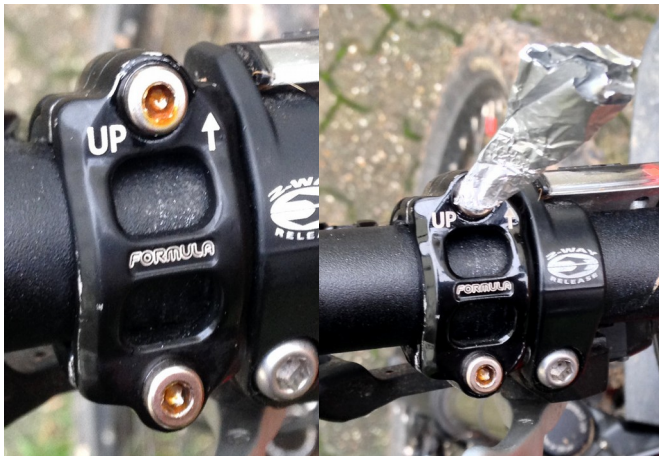
Abb. 4 Flugrost mit Öl und Alufolie entfernen
