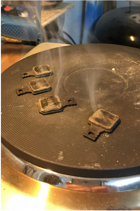
Abb. 26 Die Bremsbeläge auf eine Herdplatte legen, xlacherx@mtb-news.de -DANKE!
