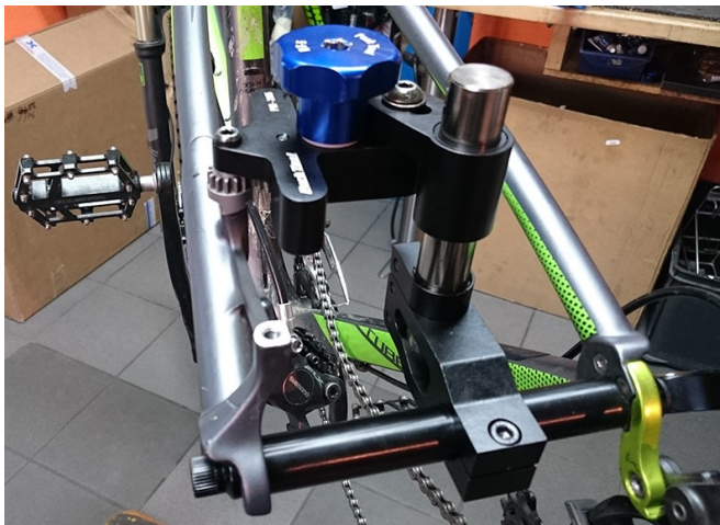
Abb. 45 PM Aufnahme planfräsen, Pixelsign@mtb-news.de -DANKE!
