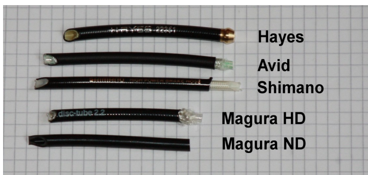
Abb. 73 Aufbau von Bremsleitungen
