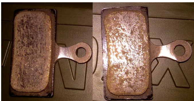
Abb. 63 Beläge mit fleckiger Oberfläche, log11@mtb-news.de -DANKE!
