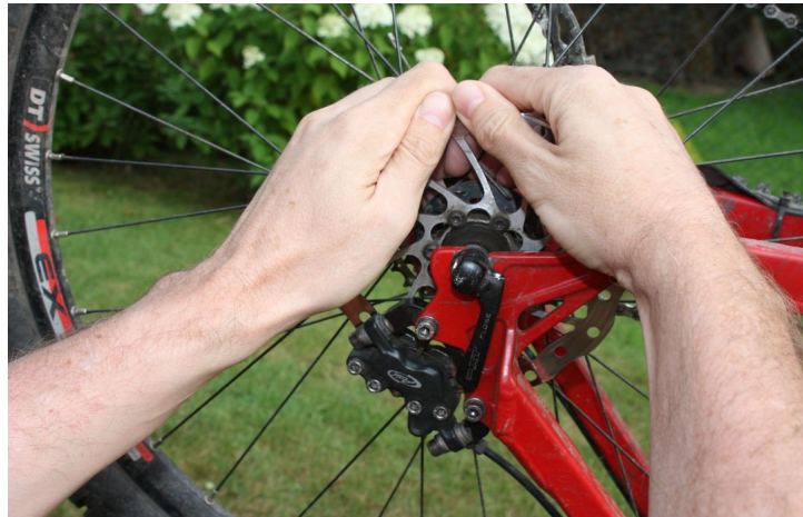
Abb. 18 Die Bremsscheibe nach innen drücken.
