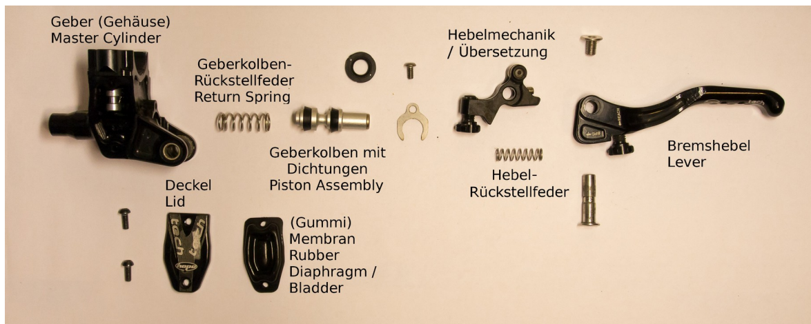
Abb. 67 Bremshebel (Hope) zerlegt, Mountain_Screen@mtb-news.de -DANKE!
