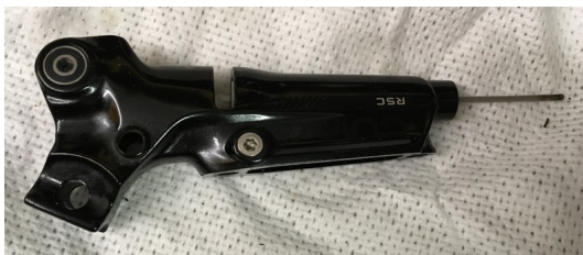
Abb. 32 Geberkolben rausdrücken
