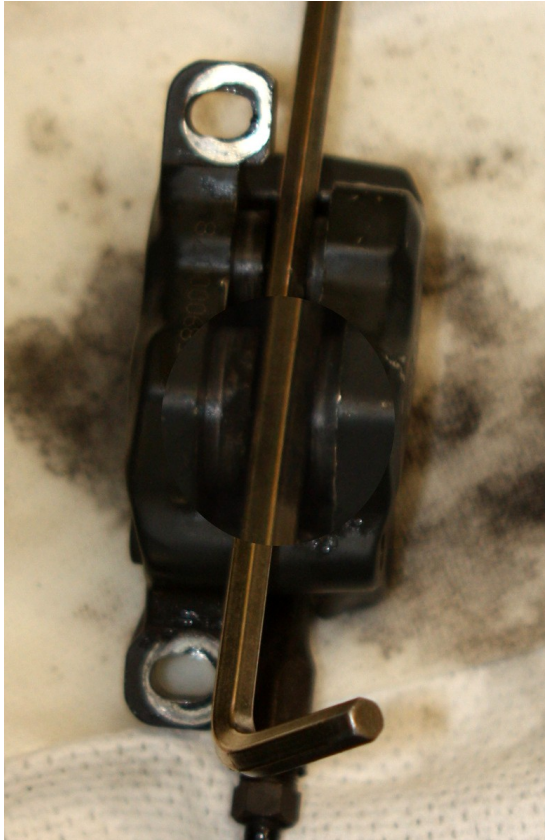
Abb. 16 Inbus reinlegen, Macken im Bremskolben
