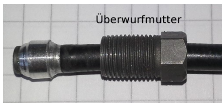
Abb. 69 Leitungsanschluss am Bremshebel
