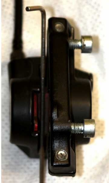
Abb. 12 Bremsbeläge vorausrichten
