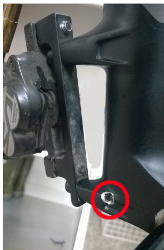
Abb. 41 Zu lange Schraube, Boschie@mtb-news.de -DANKE!
