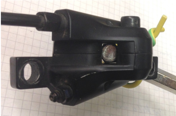
Abb. 9 10mm Inbus zwischen den Bremskolben
