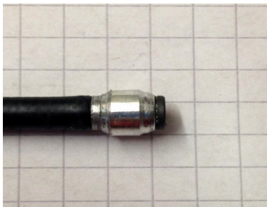
Abb. 58 Klemmring verformt
