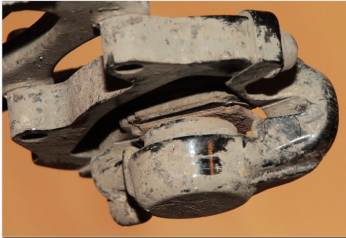
Abb. 5 Total vergammelter Bremsattel, von Anonym – DANKE!
