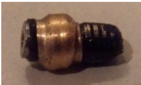
Abb. 72 Shimano Leitungsanschluss von hofi07@mtb-news.de – DANKE!
