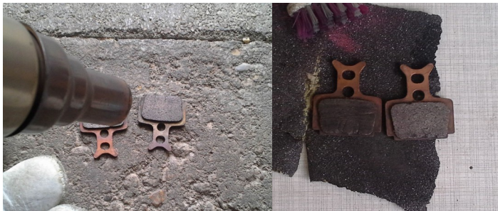
Abb. 25 Bremsbeläge Heiß machen und abschleifen
