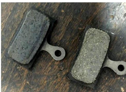
Abb. 64 Verglaste Bremsbeläge, reneweis@mtb-news.de -DANKE!
