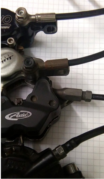
Abb. 74 Leitungsanschluss am Bremsmaster
