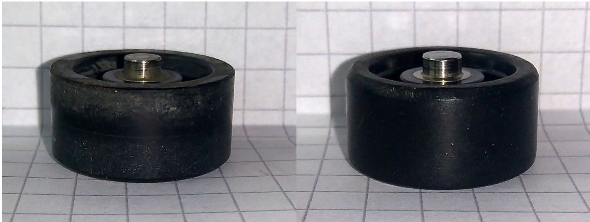
Abb. 30 Bremskolben vor und nach der Bearbeitung
