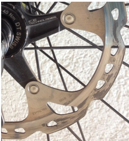
Abb. 66 ICE-Tech Bremsscheibe verschlissen, Martin W.@mtb-news.de -DANKE!
