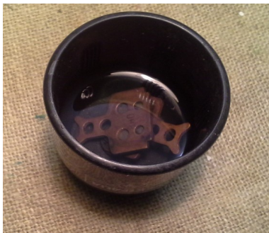
Abb. 24 Bremsbeläge in Spiritus
